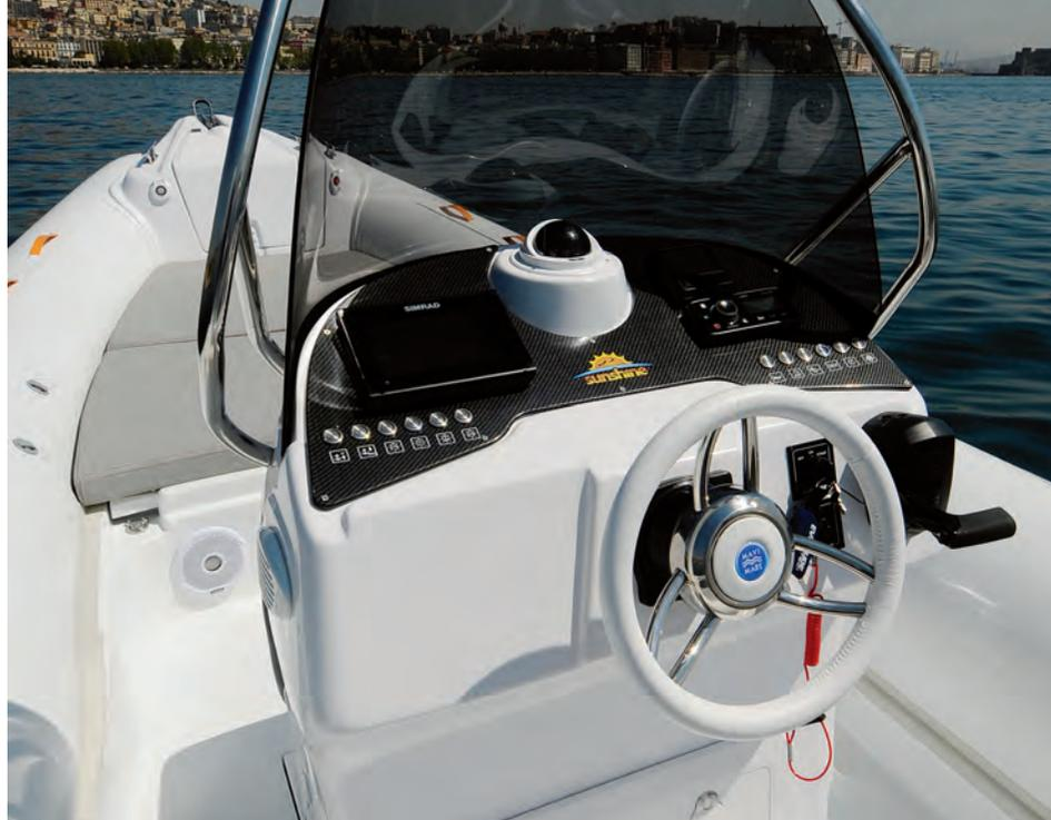
Il roll-bar è in vetroresina (come sull'esemplare utilizzato per il test) o in acciaio e supporta il tendalino parasole. Sulle mastre ci sono due piccoli gavoni ideali per riporre le cime d'ormeggio. Il pozzetto motore è diverso da quello del 745 Artik: ora c'è un'ampia plancetta comodamente calpestabile rivestita in teak (a richiesta) che si prolunga ben oltre i tubolari.
